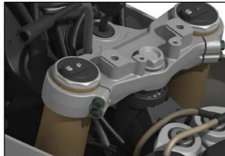
Tenere l'asta dell'ammortizzatore anteriore per allentare il bullone di bloccaggio della scheda alleata inferiore [1] da rimuovere prima dell'ammortizzatore [2].
